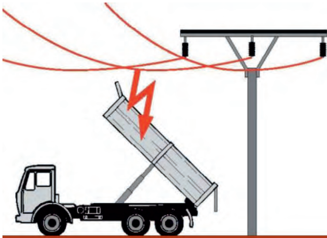
Abbildung 4: Berühren einer 20kV-Leitung beim Entleeren eines LKW's
